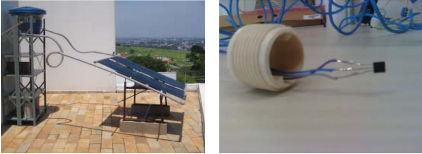
FIGURA 4 – Imagem do Aquecedor Solar desenvolvido (à esquerda). Imagem do sensor de temperatura DS1820 utilizado no experimento (à direita).
