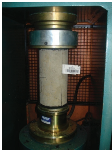
Figura 4 - Determinação da resistência à compressão.
