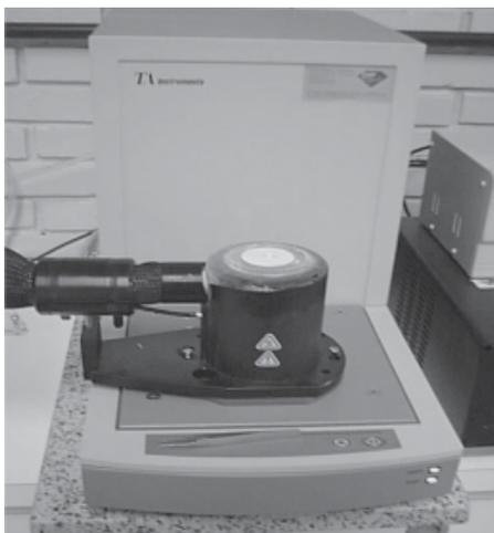
**Figura 1-** Equipamento de DSC, Lab. de Polímeros – ULBRA
