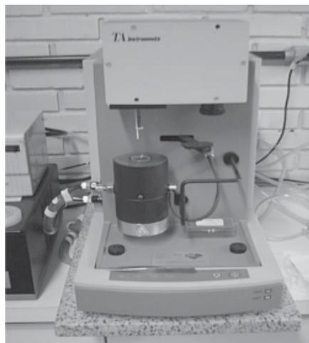
**Figura 2 -** Equipamento de TGA, Lab. de Polímeros – ULBRA
