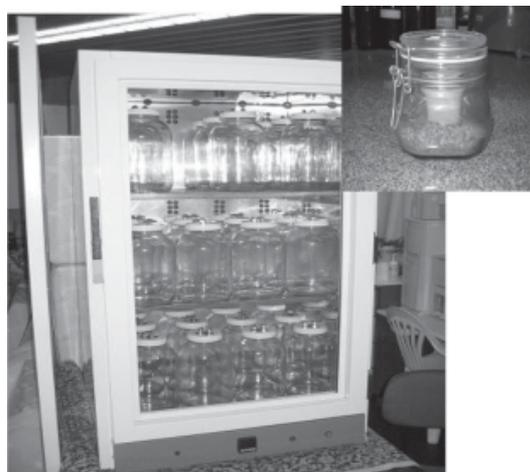
**Figura 4 -** Respirômetro e célula respirométrica.
