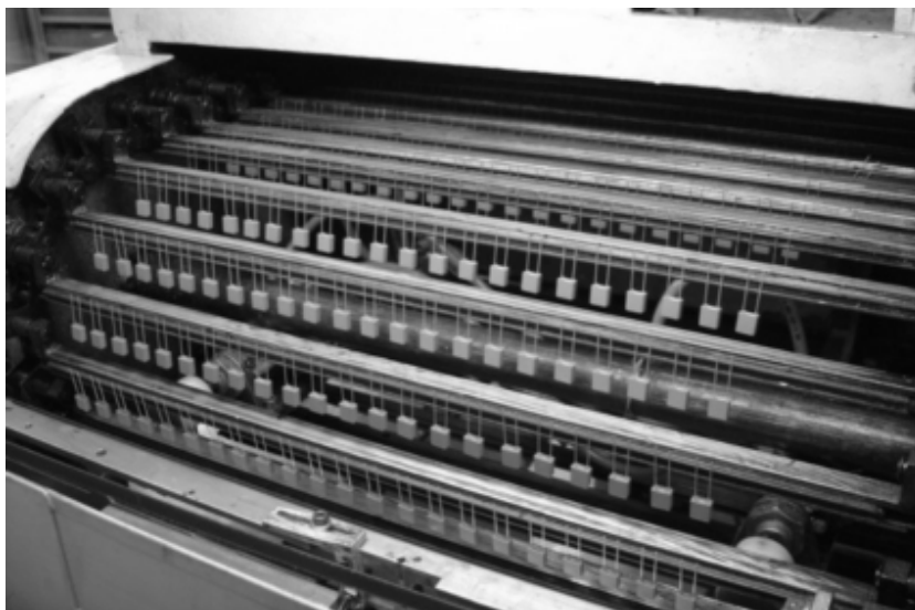
Figura 3 - Capacitores em contato com réguas magnéticas (os terminais do capacitor são de material ferromagnético). Estas réguas levam, através
