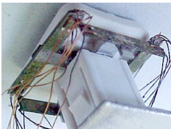
Figura 10 – Vista inferior da estrutura da plataforma de força.
