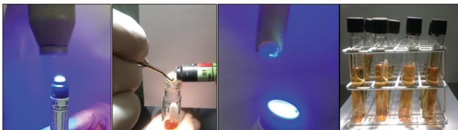
Figura 1 - Obtenção das amostras de resina composta.
