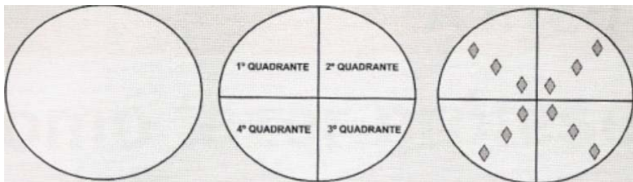
FIGURA 5 – Superfície do corpo-de-prova dividada em quatro quadrantes, com as respectivas indentações (adaptado de Souza et al., 2005).
