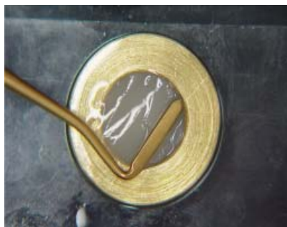
FIGURA 2 – Inserção do material restaurador na matriz metálica.
